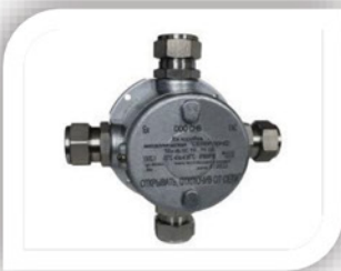
Ex коробка металлическая «СЕВЕРЛЕНД» 1Ex db IIC T6...T5 Gb X или 1Ex db IIC T6...T3 Gb X IP66/IP68 Траб. от - 70°C до + 95°C
