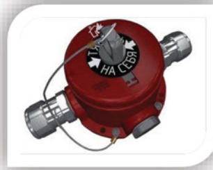
Извещатель пожарный ручной ИПР 535-Exd-A «МОРОЗ» ИПР 535-Exd-B «МОРОЗ» 1Ex db IIC T6...T5 Db / Ex tb IIIC T85°C...T100°C Db / Ex ia IIIC T85°C...T100°C Da IP66 Траб. от - 60°C до + 95°C
